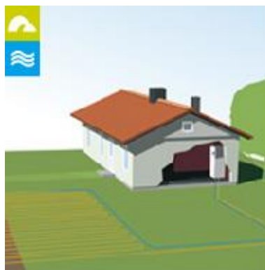
B- plošný kolektor
