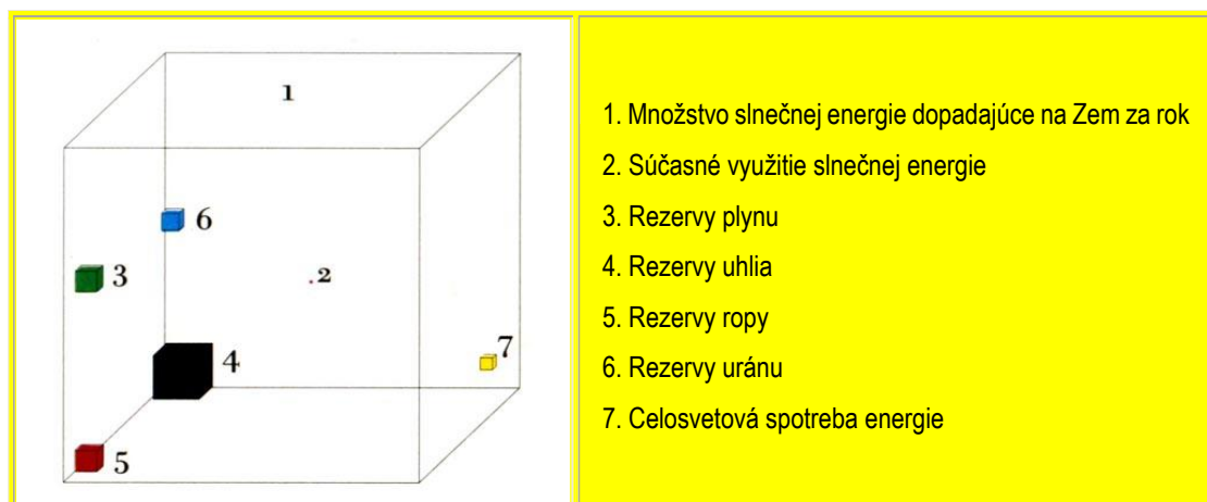
Obr. 6.9 Porovnanie energie dopadajúcej na zemský povrch zo Slnka s celosvetovou potrebou energie za rok a zásobami fosílnych palív
