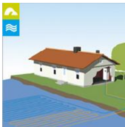
B- voda pôvodom povrchová s odberom cez plošný kolektor
