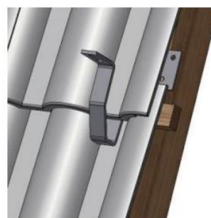
Uchytenie strešného háku vrchnou škridľou
