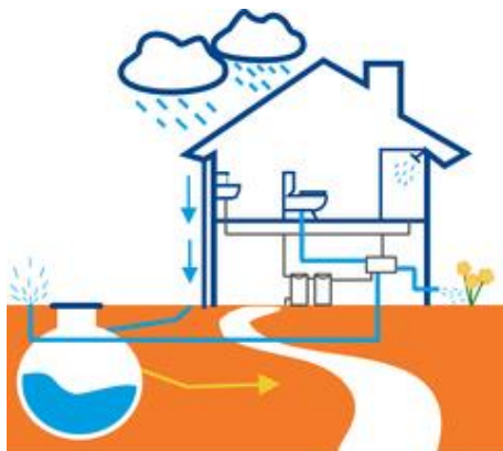
Obr. 5.12 Schéma využitia rôznych druhov odpadových vôd v budove a v jej okolí
