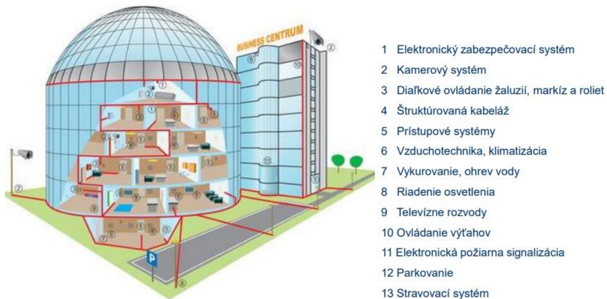
Obr. 7.13 Príklad inteligentnej administratívnej budovy II
