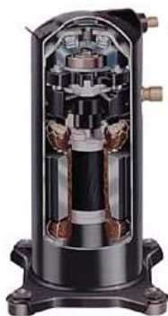
Obr. 2.5 Scroll kompresor
