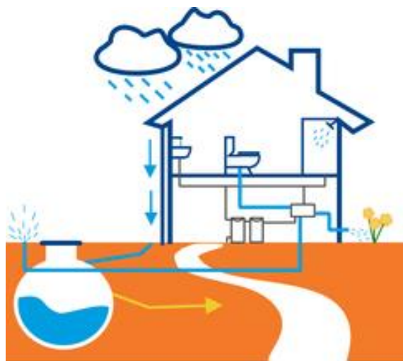
Obr. 5.7 Schéma využitia rôznych druhov odpadových vôd v školskej budove a v jej okolí
