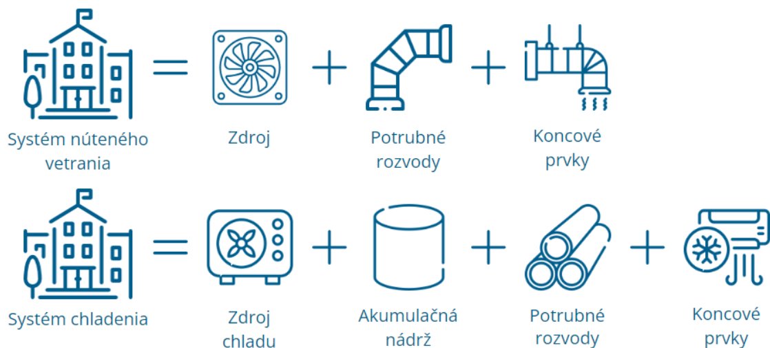
Obr. 4.33 Všeobecná schéma základných prvkov systému núteného vetrania a chladenia
