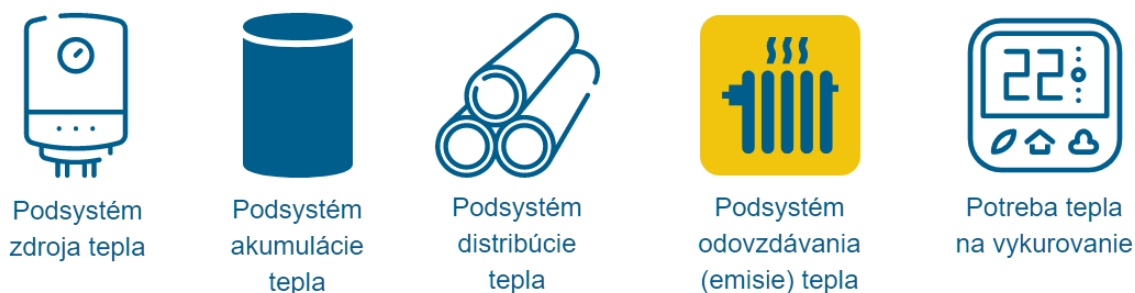
Obr. 4.53 Systém vykurovania – podsystem odovzdávania (emisie) tepla
