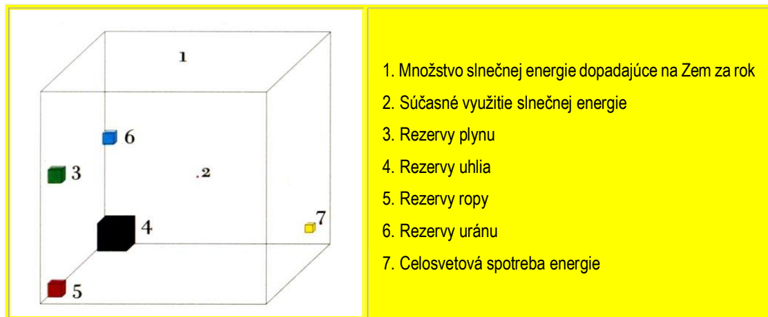
Obr. 6.2 Porovnanie energie dopadajúcej na zemský povrch zo Slnka s celosvetovou potrebou energie za rok a zásobami fosílnych palív
