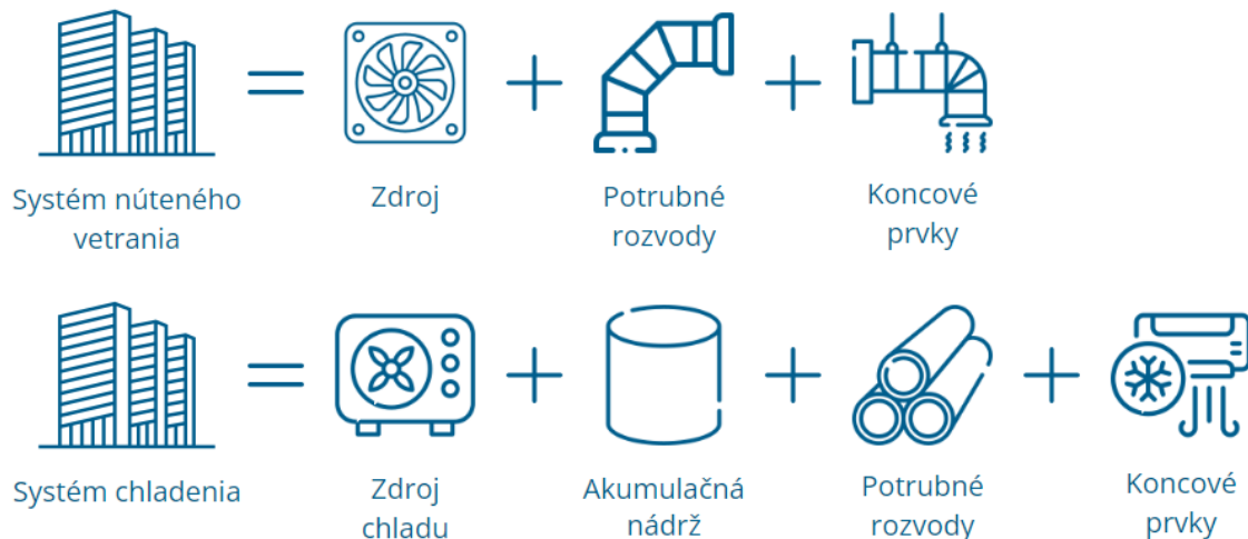
Obr. 4.37 Všeobecná schéma základných prvkov systému núteného vetrania a chladenia
