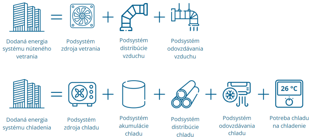
Obr. 4.47 Dodaná energia systému núteného vetrania a chladenia
