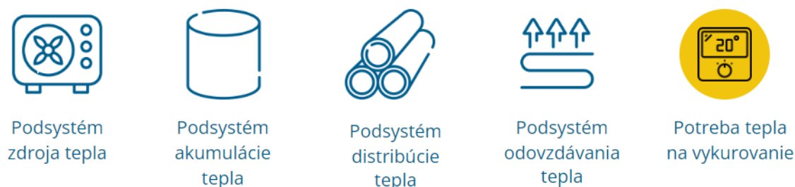
Obr. 4.28 Systém vykurovania – potreba tepla na vykurovanie
