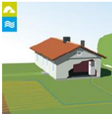
B- plošný kolektor
