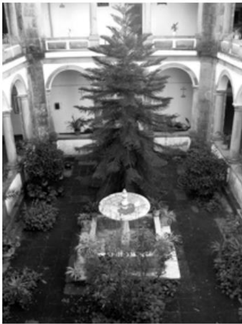
Obr. 2.27 Adiabatické ochladzovanie priestoru fontánou a tienenie zeleňou
