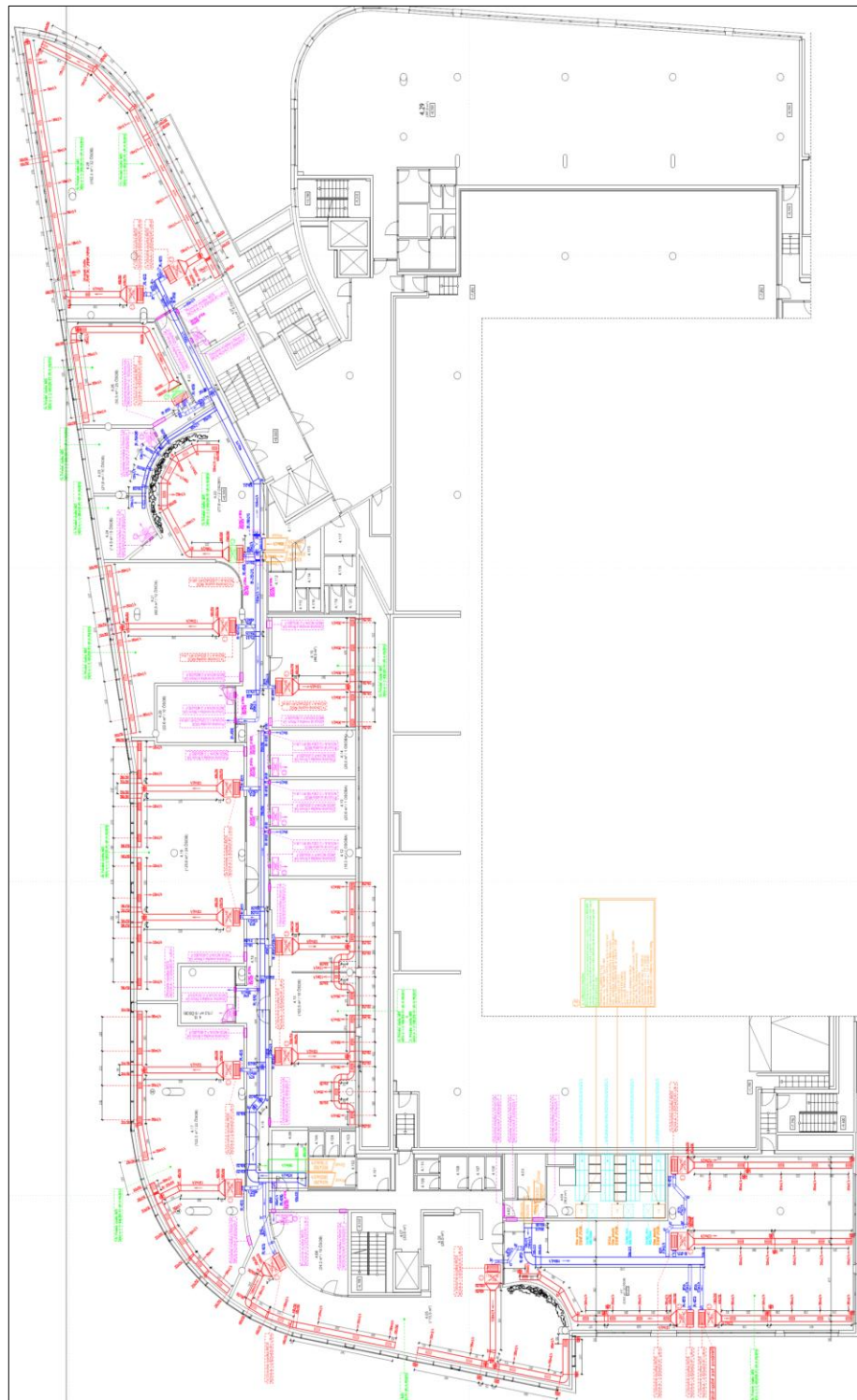
Obr. 2.44 DCV vetranie v AB2 – kancelárie autonómne zóny a 1 centrálna VZT jednotka – vzorový výkres (pôdorys 4.NP)
