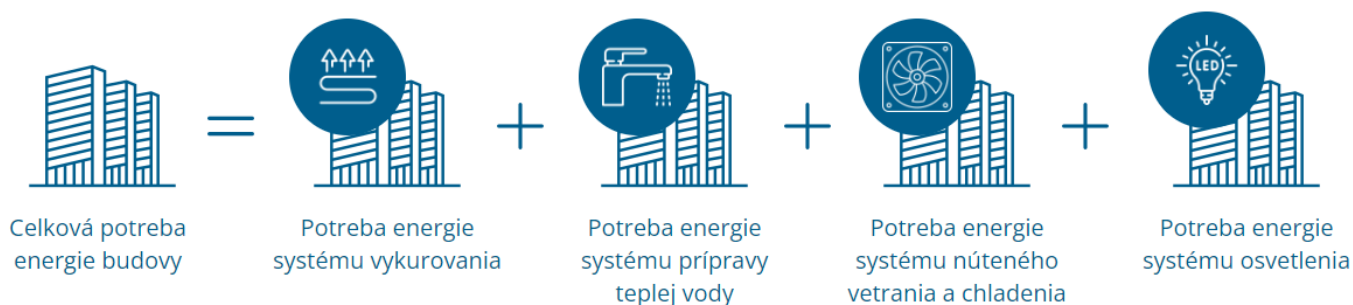
Obr. 4.49 Celková potreba energie budovy
