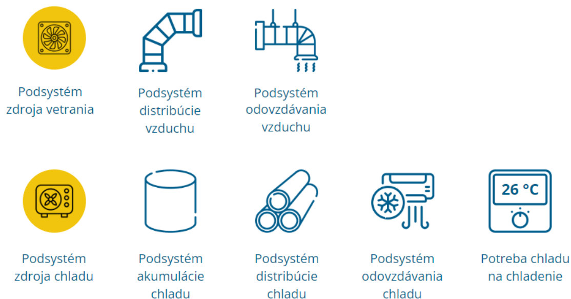
Obr. 4.46 Systém núteného vetrania a chladenia – podsystem zdroj vetrania a zdroj chladu
