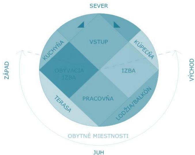
Obr. 4.24 Príklad ideálnej orientácie budovy na bývanie vzhľadom k svetovým stranám – vnútorné dispozičné usporiadanie
